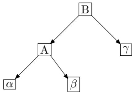
Rotace funguje, kácí-li se strom ke kraji (tedy balance syna vrcholu s balancí 2 nemá jiné znaménko než rodič)
